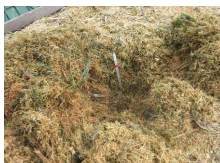
内部温度の測定
